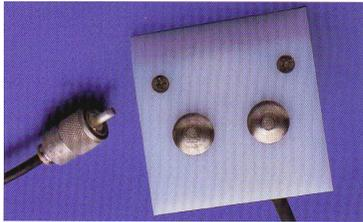
SONDE 1986 POUR PRESSE, pour le contrôle continu pendant le pressage. Un câble relie la sonde installée dans la presse au boîtier électronique dans la cabine. Peut-être utilisée avec tous les modèles. Le FX-2000 est particulièrement adapté pour le fonctionnement
