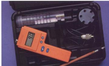
COFFRET comprenant F-2000, poignée H-3, sonde 830-2 de 25cm et sonde 831 à pointe courtes.
